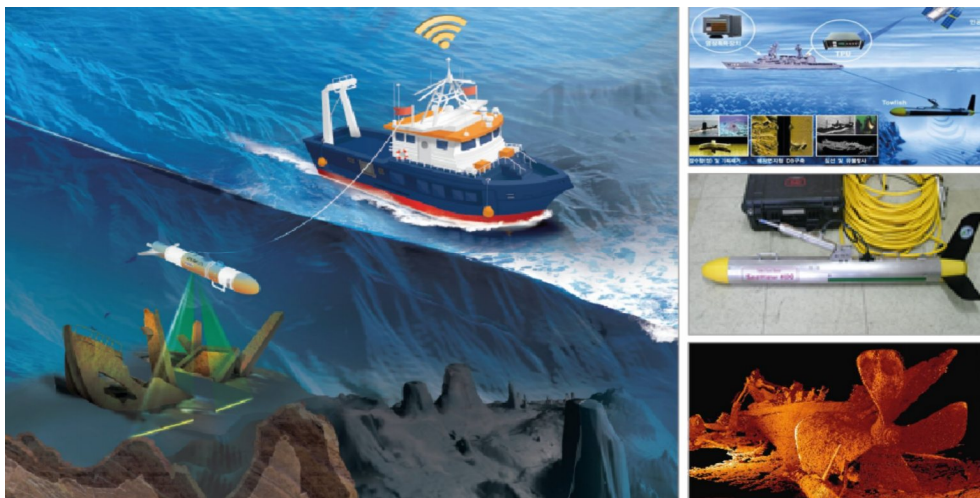
[ 그림 26 ] 해저면 영상조사 운용모식도 및 방법
