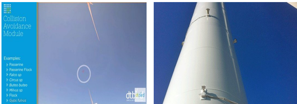
[ 그림 91 ] 충돌 자동 탐지 및 터빈 통제 시스템 해외 사례(스페인)
