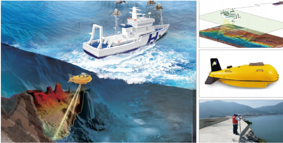
[ 그림 27 ] 해저지층탐사 운용모식도 및 방법
