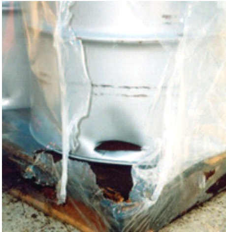
지게차에 찢려 손상된 드럼 - 드럼 수납작업 시 발생하는 가장 일반적인 손상 원인
