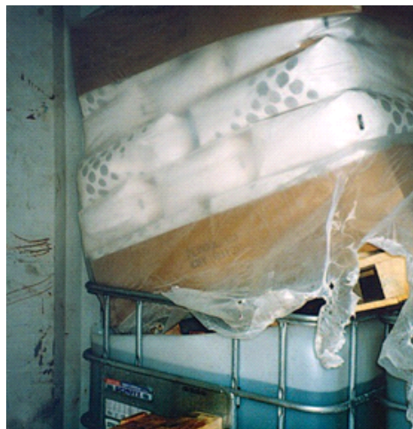
상단에 겹침적재된 화물의 팔레트가 하단 중형산적용기(IBCs)의 금속 골조를 파손하여 플라스틱 내용기 일부분이 찌그러졌다.
