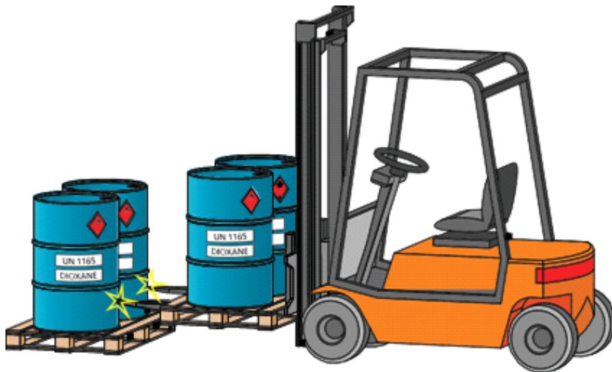
지게차에 찢려 손상된 드럼 - 드럼 수납작업 시 발생하는 가장 일반적인 손상 원인
