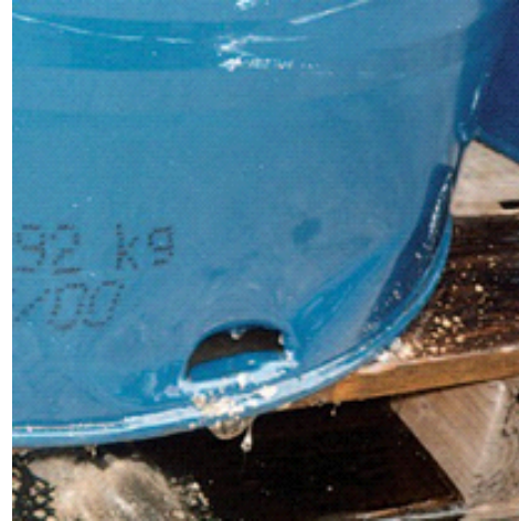
지게차에 찢려 손상된 드럼 - 드럼 수납작업 시 발생하는 가장 일반적인 손상 원인
