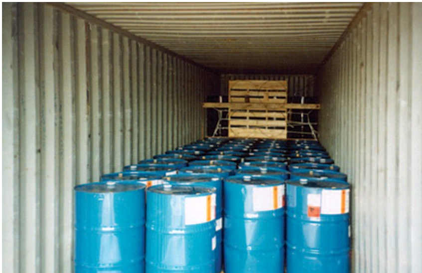
버팀목(timber strut), 로프 및 팔레트로 구성된 화물 “문(gate)”
