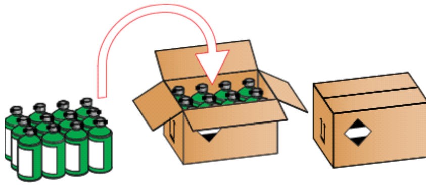
위험물 포장에 사용되는 전형적인 결합용기의 구조 : 별도의 내장용기를 파이버보드 외장용기 내부에 수납
