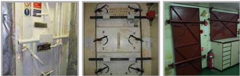
[ 선원대피처 설치 예시 ]
