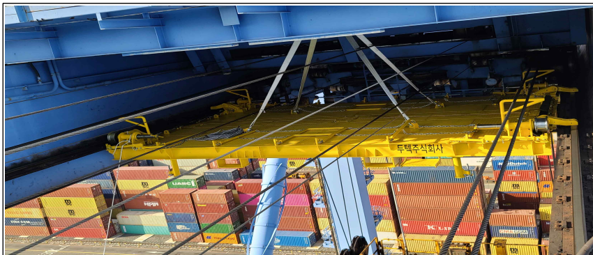
원격제어 라쳇암 장착 안전 정비 트롤리 - 트롤리 레일 안착(설치) 사진
