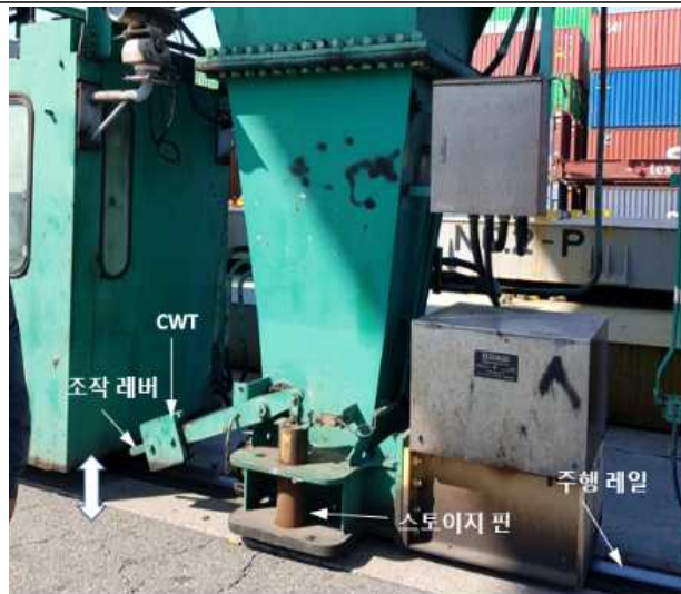
(수동식) 스토이지핀장치 사진 및 도면
