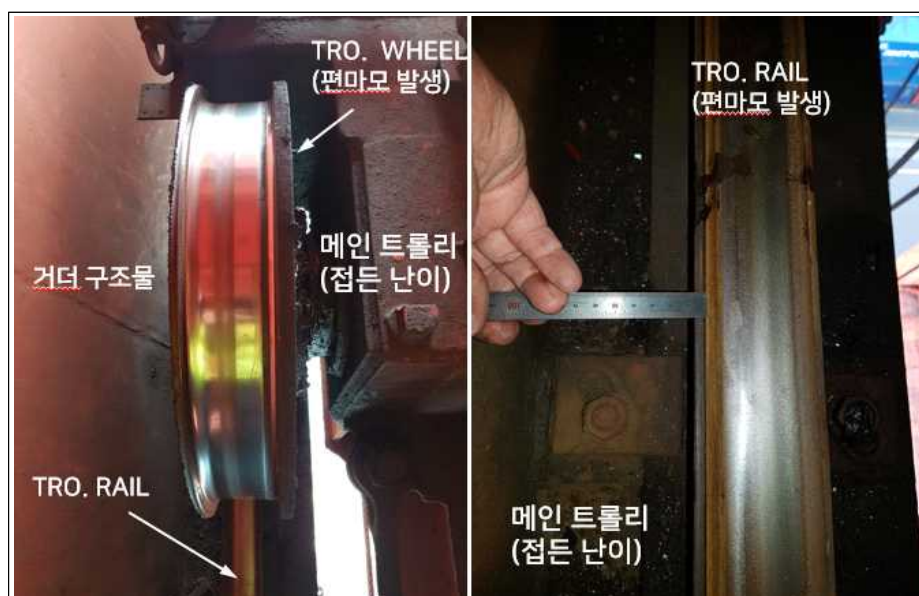
컨테이너크레인 메인 트롤리 Wheel과 Rail 편마모 발생 - 메인 트롤리 상면에서 Trolley Rail 접근 난이(어려움)
