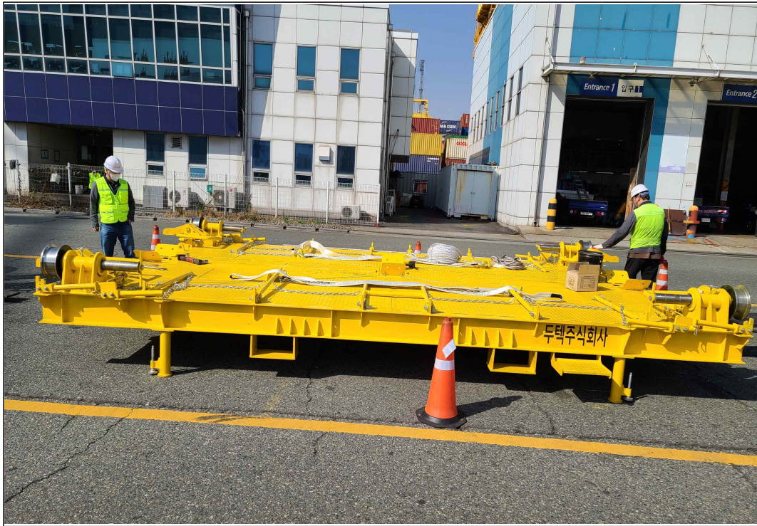
원격제어 라쳇암 장착 컨테이너크레인용 안전정비 트롤리 - 지상 조립 사진
