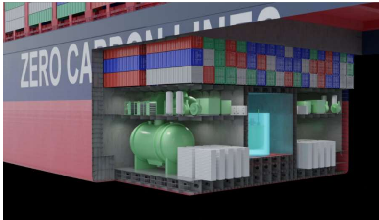
〈원자력 선박 추진시스템 배치도 이미지, 출처: 미국선급협회(ABS)〉
